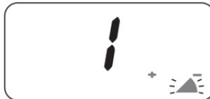
Lorsque les piles sont faibles, l'appareil tombe en mode de piles faibles/sommeil. Les modes de balayage, de monitoring, de transmission, de transmission de la tonalité d'appel, du réglage de la tonalité "CTCSS", du réglage du niveau de sensibilité de l'activation par la voix "VOX" et de la vibration sont désactivés. Remplacez rapidement les piles afin de continuer d'utiliser toutes les fonctions de la radio.
