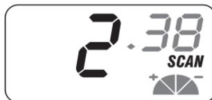
S'il y a présence d'un signal, la radio arrêtera sur ce canal actif. Elle demeurera sur ce canal jusqu'à la fin de la transmission. Après deux secondes, elle continuera son balayage.
